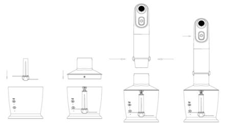
1. Установите ножи измельчителя на штырь внутри емкости для измельчения, нажмите на насадку так, чтобы раздался щелчок, означающий, что насадка надежно зафиксирована.
