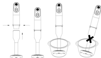
1. Приложите насадку к корпусу с двигателем и прижмите до фиксации, при этом должен раздаться щелчок.
