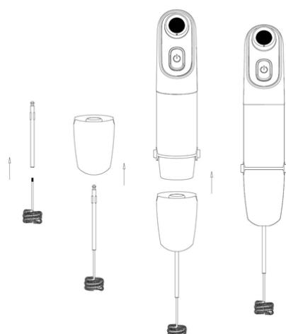
1. Вставьте нижнюю часть насадки в верхнюю и поворачивайте по часовой стрелке.
