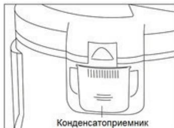
После каждого приготовления необходимо снять и опустошить конденсатоприемник, расположенный у основания петли крепления крышки мультиварки. Промойте, просушите его и установите на место.
