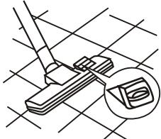
**Поз 2. Использование щетки для полов с ковровым покрытием.**
