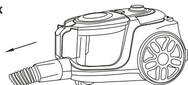
При смещении наконечника насадки для обивки по стрелке, указанной на ее корпусе, она преобразуется в насадку для щелей.
