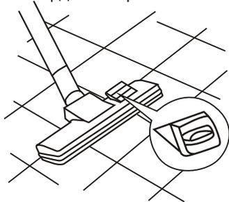
**Поз 2.** Использование щетки для полов с ковровым покрытием.
