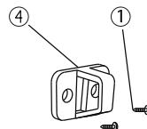
Примечание: Если петля замка не блокирует замковую часть при установке, пожалуйста, открутите винты с круглой головкой на задней стороне дверцы ⑤ и отрегулируйте положение верхней и нижней части дверцы, чтобы замок блокировал ее. Затем вкрутите винты, чтобы зафиксировать положение.
