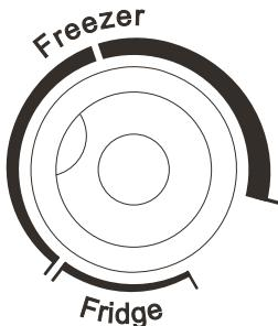
Регулятор терmostата, расположенный на панели управления служит для установки настроек температурного режима внутри морозильной камеры.
