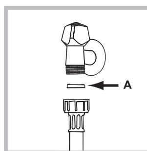
1. Вставьте прокладку А в конец заливного шланга и наверните его на вывод водопровода холодной воды с резьбовым отверстием 3/4 дюйма (см. рис.).
