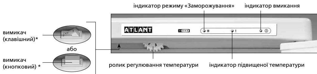
Рисунок 2 – Морозильник (вигляд зверху)
