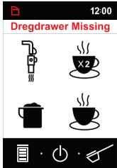
На дисплее отображается индикация (Dregdrawer Missing – Отсутствует контейнер для гущи), изображенная выше, если в кофемашину не установлен контейнер для гущи или он установлен неправильно.
