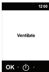
Если в трубках кофемашины воздух, отображается индикация «VENTILATE» («Вентиляция»). В этом случае необходимо слить воду. Для того чтобы слить воду выключите кофемашину переключателем питания на корпусе, а затем снова включите её переключателем питания на корпусе. Коснитесь дисплея, и кофемашина начнет предварительный разогрев, а затем перейдет в режим самоочистки.
