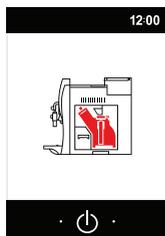
На дисплее отображается индикация, изображенная выше, если в кофемашину не установлен варочный блок или он установлен неправильно.
