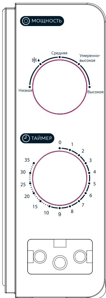
На панели управления расположены регулятор мощности работы микроволновой печи и регулятор времени приготовления/веса размораживаемых продуктов.
