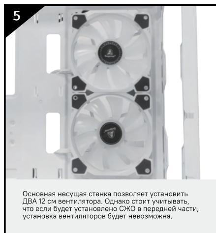
Основная несущая стенка позволяет установить ДВА 12 см вентилятора. Однако стоит учитывать, что если будет установлено СЖО в передней части, установка вентиляторов будет невозможна.
