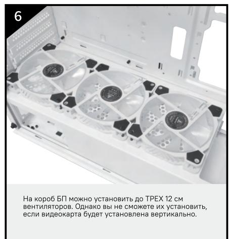
На короб БП можно установить до TPEX 12 см вентиляторов. Однако вы не сможете их установить, если видеокарта будет установлена вертикально.
