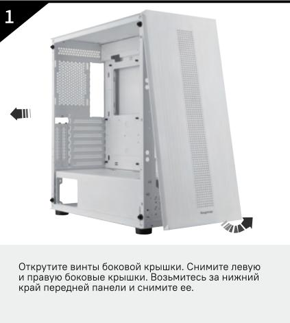
Открутите винты боковой крышки. Снимите левую и правую боковые крышки. Возьмитесь за нижний край передней панели и снимите ее.
