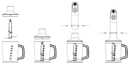
1. Установите ножи измельчителя на штырь внутри емкости для измельчения, нажмите на насадку так, чтобы раздался щелчок, означающий, что насадка надежно зафиксирована.
