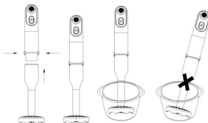
1. Приложите насадку к корпусу с двигателем и прижмите до фиксации, при этом должен раздаваться щелчок.
