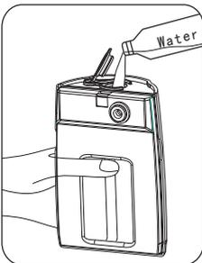
2. Откройте крышку резервуара и залейте в резервуар водопроводную воду не меньше чем на одну треть и не выше максимальной отметки.
