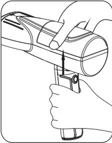
1. Отсоедините резервуар для воды от корпуса прибора, взявшись по бокам и потянув резервуар вверх.
