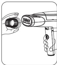
Чтобы установить насадку, возьмитесь за язычки по бокам насадки и приложите ее к рабочей поверхности прибора, затем прижмите до фиксации.
