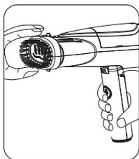
Чтобы снять насадку, возьмитесь за язычки и отсоедините.
