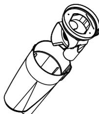
4. Извлеките из контейнера для сбора пыли циклонный фильтр.
