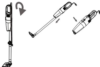
3. Если вы собираетесь использовать пылесос в компактном виде, не присоединяйте удлинительную трубку. Если трубка уже присоединена и пылесос полностью собран, сначала снимите шнур питания с держателей, а затем отсоедините удлинительную трубку.
