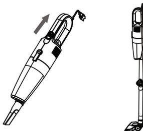
По окончании нажмите кнопку включения/выключения, чтобы выключить пылесос. Отсоедините вилку питания от розетки. На время хранения можно намотать шнур питания на крючки.
