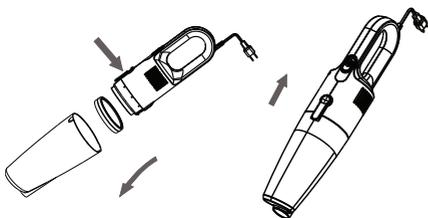
1. Нажмите кнопку снятия контейнера для сбора пыли и убедитесь, что в контейнере для сбора пыли установлен циклонный фильтр и фильтр двигателя и снова закрепите контейнер на корпусе пылесоса.
